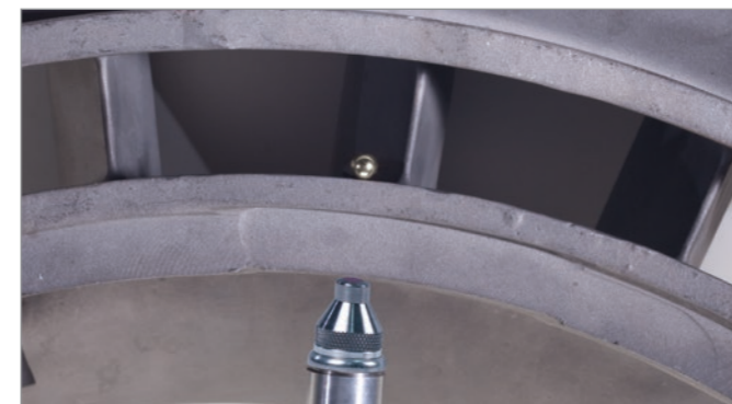
Измерение толщины деталей из литого металла 24,1 мм, используемых в аэрокосмической промышленности
