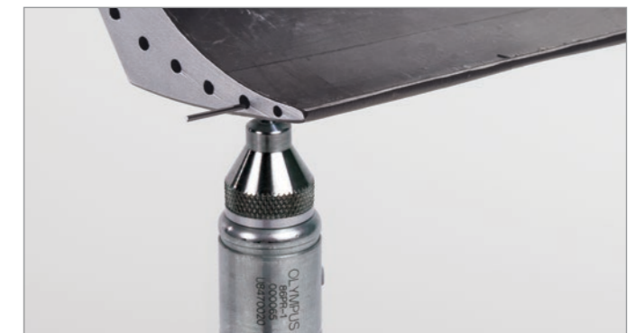
Измерение толщины стенок лопаток турбин с использованием стальной проволоки
