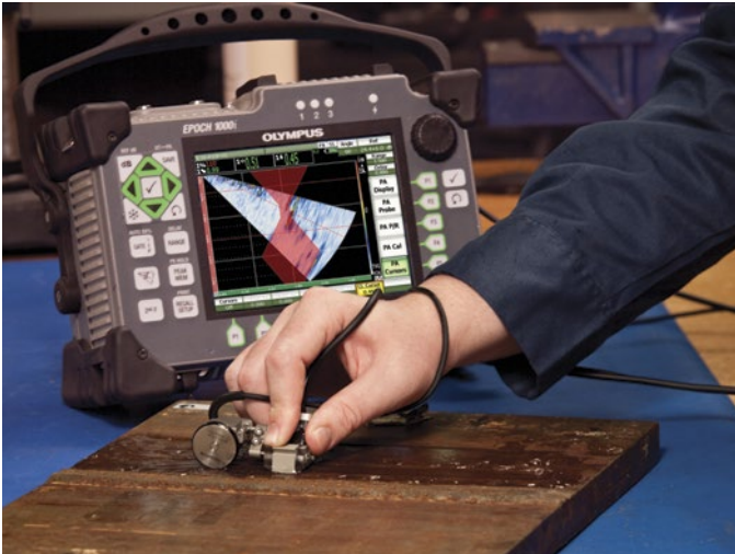
S-скан с отображением профиля сварного шва
