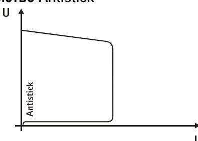
Устройство Antistick предотвращает прокаливание электрода.
